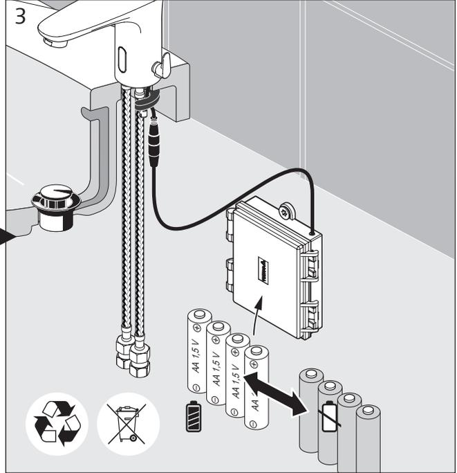
**DE Not-Aus Funktion bei zu geringer Spannung**
